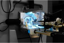
Fig. 3: Nanospray Flex™ ion source (Thermo Scientific<sup>™</sup>).
